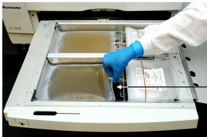
Guide de positionnement destiné à la tubulure de transfert
