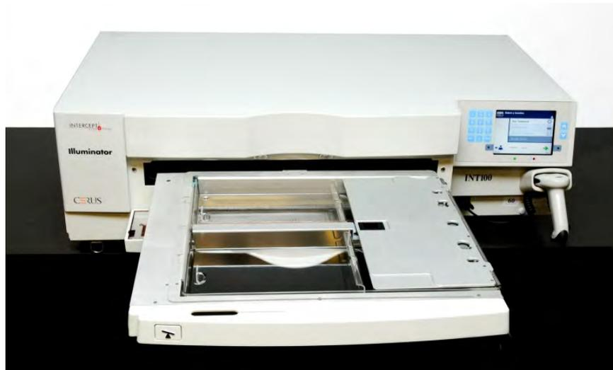
Les deux compartiments de droite possèdent un couvercle, afin de maintenir le kit et la tubulure durant l'agitation. L'opérateur ouvre ce couvercle pour charger le kit, puis le ferme avant le début de l'illumination.
